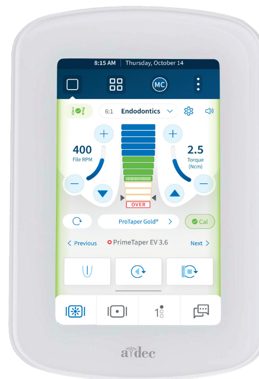
Integrovaný apex lokátor Midwest přesně detekuje a během práce zobrazuje polohu endodontického nástroje vzhledem k apexu kanálku na dotykové obrazovce DS5.
